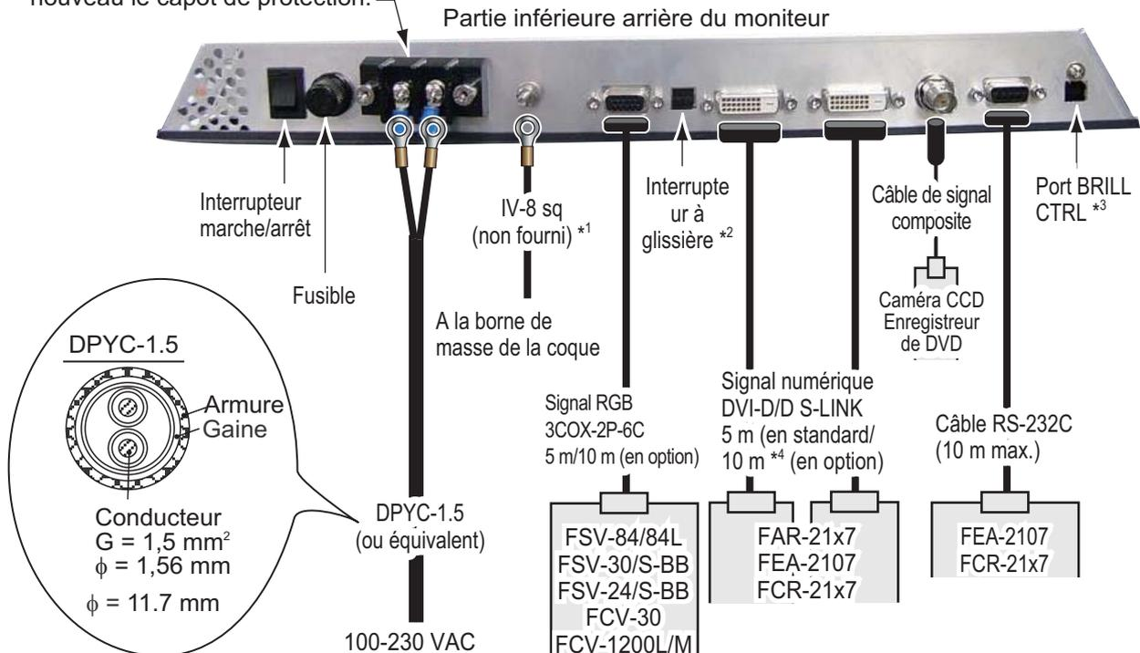
\*1: Fixez une cosse à sertir (diamètre intérieur de  $\phi 4$ ) côté moniteur. Faites en sorte que le fil de masse soit le plus court possible.
