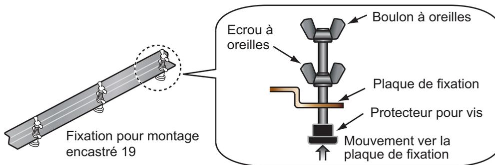
6. Fixez la fixation 19 pour montage encastré sur les côtés droit et gauche à l'arrière de l'unité de surveillance à l'aide des vis à rondelle B (6 vis).
