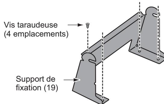
3. Fixez le support à l'arrière de l'unité de surveillance à l'aide des vis à tête de serrage (9 vis).
