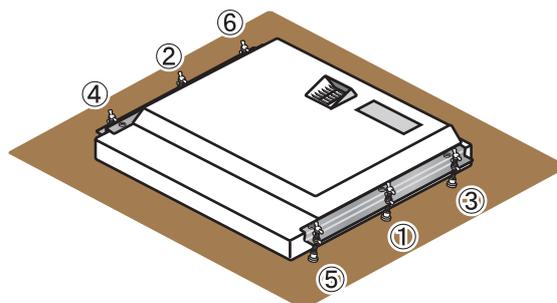
8. Serrez fermement les boulons à oreilles pour fixer l'unité de surveillance.
