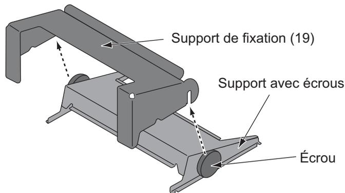
2. Fixez le support de montage à l'emplacement de montage à l'aide de quatre vis taraudeuses.
