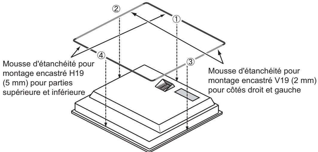
3. Fixez les panneaux 19 de montage encastré à l'unité par l'arrière, à l'aide des vis à rondelle B (6 vis, fournies).
